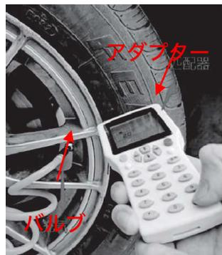
機器をゆっくりと上下に動かし、エアノズルに近づけて確定ボタンを押し、ゴムタイヤの端に軽く上下に動かします。この時、ディスプレイ上部に「マッチングコード」が表示されます。「ピー」という音が鳴ったら、マッチング機器がタイヤ内のセンサーを読み取り、機器が信号を受信してペアリングを完了します。
