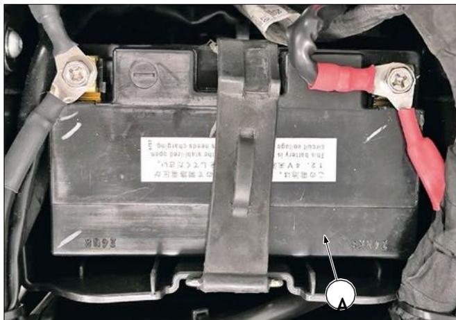
バッテリーを取付ける際は、図のようにプラス端子を差し込み、次にマイナス端子を接続してください。
