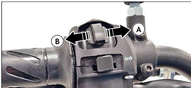
メニューのトリップA とトリップBの場合のみ、「モードセレクトボタン」を長押しすると、対応するトリップ計をリセットできます。
