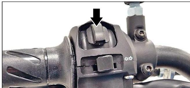
「モードセレクトボタン左」と「モードセレクトボタン右」を短く動かすとメニューを移動でき、「モードセレクトボタン」を短く押すと、対応するメニューに入ることができます。
