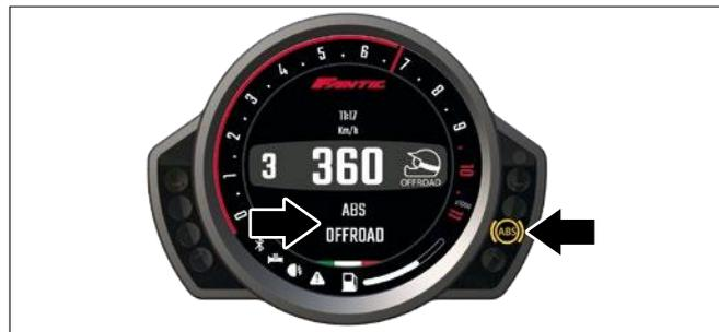
ABSステータスが「オフロード」または「オフ」にある時、「ABS」ボタンを短くまたは長押しするとABSはオンの状態になります。再アクティブ化すると、メインインフォメーションウィンドウにポップアップメッセージが表示されます。
