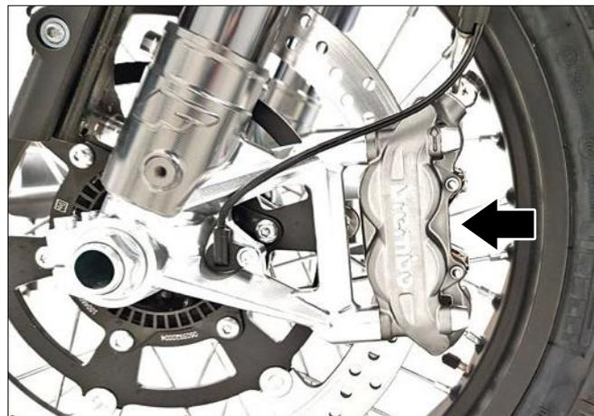
フロントブレーキキャリアの場合はキャリアホイールピンの方向を下から上に、リアブレーキキャリアの場合はリア上部から見て、ディスクとパッドの間の目視点検を行います。
