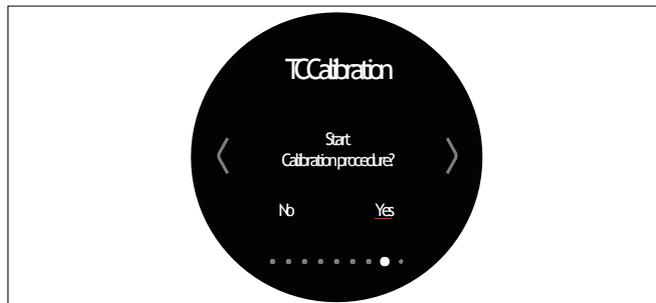
メインインフォメーションウインドウに“TC Calibration Started” “Calibration Needed” というワーニングポップアップが表示され、トラクションコントロールのステータス表示が点滅し始めます。その後、60秒以内に直線で50 km/h ± 5 km/hの速度に達し、トラクションコントロールのステータス表示が消灯するまで、その速度を維持する必要があります。この手順は数秒かかる場合があります。
