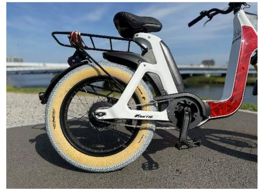
タイヤの仕様はオリジナルの『スピードスター』から変更なく、VEE Tireが誇るB-PROOF（アラミド・ベルト）構造。5mm厚の保護層をトレッド裏面に用意し、パンクなどに極めて強い構造としている。ミニマリストティックなトレッドパターンながら、センター部分をハニカムデザインとして回転抵抗を削減したのも特徴だ。。軽快に走らせながらもコーナリング・グリップを上げるためにサイドにかけてはMPC（マルチパーパス）コンパウンドを与えられ、高い走行性能と耐久性を両立させている。
