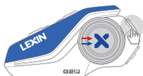
インカムボタンを約2秒間長押しすると、LEDランプが赤青に点滅します (2台目のG2P)
