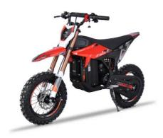
eFOX SS: Nicotが目指す電動モーターサイクルの一つが、スポーツオフロードモデルだ。eFOXはオリジナルのフレームにパワフルな10kwモーターを搭載。トランスミッションを備えたモデルの提供を目指し実証実験を重ねてきたが、コストバランスやマーケットニーズからまずはシングルモーターで市販モデルをまとめ上げた。コストパフォーマンス最強の電動オフロードモデルとして、ゲームチェンジャーを目指す。希望小売価格:740,000円(消費税10%込)
