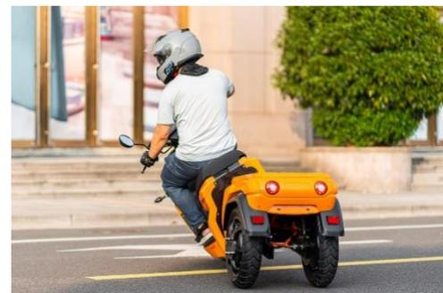
前半部分を共有するモジュール構造の二輪タイプは、リーズナブルさが特徴。搭載されるモーターは1個ながら、軽量を武器にこちらもシングルバッテリーモデルで110km以上（45km/h定値走行）の走行距離を誇り、実用性は十分以上。フロントのキャリアは3輪モデルと同じ積載容量。リアキャリアも小さいながらもメーカーオプションのボックスなら500x500x500mmのボックスが搭載可能。こちらももちろんお客さまのニーズに合わせたボックスを用意することが可能な作りだ。もちろんシート下のヘルメットスペースも同様に提供している。
