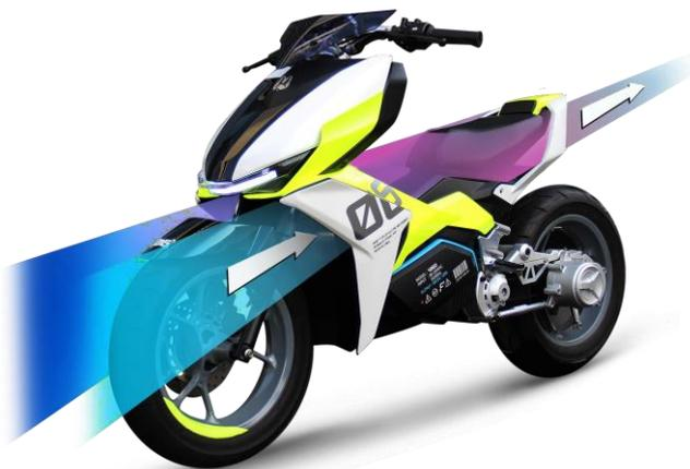
その一つがボディワークだ。一見デザイン優先の（それも十分に魅力的だが）スタイルは、風洞実験を経て磨き上げられた、あたかもGPマシンのようなウイングレットが控えめに用意されている。これにより積極的に空気の流れを活用してマシンのスタビリティを向上させるとともに、モーター部分への冷却風の導入によって安定した駆動力を発揮させることにも一役買っている。
