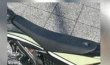
❸トレールというよりエンデュロレーサーといった座面の横幅が強いシート。表裏にはデザイン的な要素もあるが、お尻のすり下がり防止のためのディンプル仕様になっている
