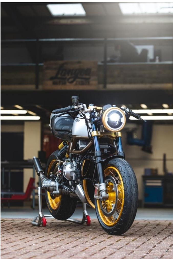
7020T6アルミニウム合金によるパイプフレームは驚くほど軽量。燃料タンクなどボディワークの随所にカーボン素材を多用して軽量化を進め、公道走行可能な保安部品をすべて装着した状態での車両重量は、120kgに抑えられている。オーリンズの正立フロントフォークやカンチレバー・スタイルのリア・デュアル・ショックアブソーバーなど、斬新なテクノロジーというよりは、既存の技術を美しく仕上げたLangenは、フルフェアリングとモノコックボディでカバーされたVinsとは全く異なる外観を持ちながらも、圧倒的な先進性を誇る唯一無二の2ストロークエンジンを搭載した、最初のストリートモデルとして、歴史に大きなステップを刻むことになるのは間違いない。生産はVinsのエンジン生産の能力に左右されるが、こちらも受注からおおむね90日程度での完成を目標として予約の受付を行っている。Langenもすでにその代理店となるモータリストで受注を受けており、2022年度中にはその第一号車が日本の路上に姿を現す予定だ。
