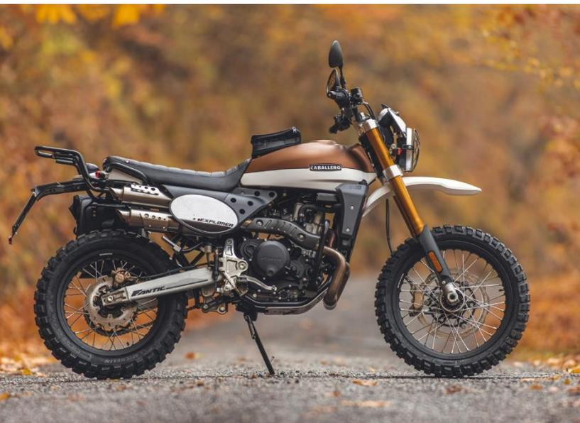
ック・キャバレロ・エクスプローラー 500」だ。スクランブラー・スタイルのキャバレロの前後にストロークの長いサスペンションを装着し、アルミニウム製スイングアームなどで足回りを強化。よりオフロード性能を高め、とどまるところを知らない旅へといざなう人気モデル「キャバレロ・ラリー」をベースとし、スタイリッシュな外観を崩すことなくキャリア、バッグなどをあらかじめそろえて用意した、ロングライド・スクランブラーだ。専用を用意されたバイカラー（ツートーン）ペイントはキャバレロの美しさにさらにプレミアム感を与え、厳しい環境規制「EURO-5」に適合する500ccのエンジンは、ミドルクラスながら余裕のある走りを軽量な車体に提供する。「エクスプローラー」は、日常から旅立ちまですべてをカバーできるアドベンチャーモデルとして、特に日本人の使い方にマッチした存在といえ
