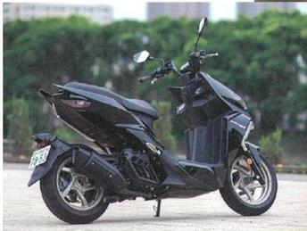
コンパクトに切り詰めた車体は、前後荷重配分をほぼ60:50とすることに成功。最大バンク角も42度と深く、スクーターの枠を超えた運動性能の良いディメンションが与えられている。
