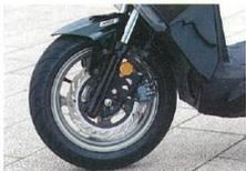
タイヤは前後13インチ。ブレーキは260mm径ローターを採用し、スポーティな走りに見合った強力なストッピングパワーを実現。
