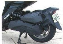
リアショックはスクーターとしては珍しいセンターマウント方式。バンク角も42度と深く、高いレベルのスポーツ性能を達成している。
