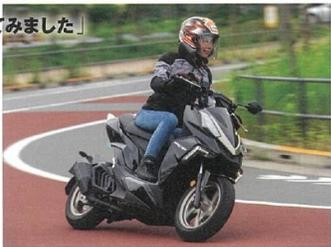
ヤの接地感が希薄になりがちだが、DRG BTの前後車重配分はほぼ50:50。大差なく、コーナー立ち上がりもフル加速でもフロントのグリップ状態が明確に伝わってくる。メインフレームはアンダーボーン形状だが剛性は充分で、前後サスペンションのスプリング減衰力の設定もスポーティ指向。バンクさせたままのブレーキングやフルバンク中にも車体がグニャクすることがなく、想定ラジをヒタリとトレースできる。車重132kg、全長1990mmと、125cc並みに軽量コンパクトな車体に、スポーティなエンジンで機動力は抜群。個性的なデザインと併せ、ひと味違うスクーターを求める人にお薦めする。(太田安治)
