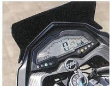
コックピットには大型の液晶ディスプレイ。ギアシフトポジションインジゲーター付きで何速に入っているのかがひと目でわかります
