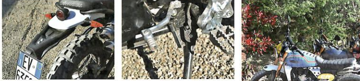
新設されたスブラッシュガード。これまでオプションとしての用意があったが、全車共通品を採用。背中への泥跳ねが大幅に改善されている 強化されたサイドスタンドマウントブラケット。曲がりやすいサイドスタンドは欧州車に共通する弱点だが、ファンティックはここを強化してアップデートした
