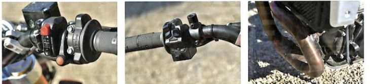
右側に新設されたのはABSキャンセルスイッチ。走行中の操作もしやすい形状に改められている 新しいハンドルバースイッチ。ヘッドライト切り替えとウィンカーが集中タイプになり、使い勝手が改善されている EURO-5に合わせて大型化されたキャタイクンバーター。位置は変わらないがはつきりわかるほどに大型化された
