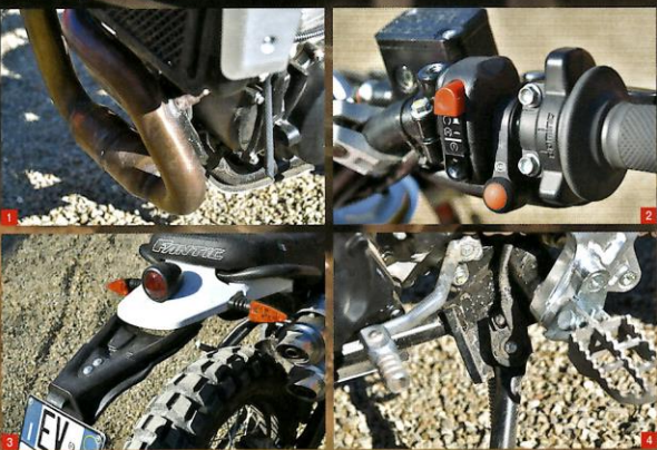
1 新排出ガス規制をクリアするために、エキゾーストパイプ内のキャタライザー(触媒)を大型化。しかし、エンジン出力は高められている。2 スイッチ類は樹脂製を採用。ABSボタンの長押しでABSを解除できる。3 オンバープレートホルダーにスプラッシュガードを装備。泥や雨の跳ね上げを低減するパーツ。4 サイドスタンドのマウント部分を強化。荷物積載状態の停車で安定性を高めてくれる。これらの変更はキャバレロシリーズすべてに施されている。日本でもすでにモーターリストにより順次出荷が始まっている。
