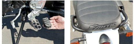
●ステップはオフロード用の上面に前が装備された大型なモノにゴムがセットされたタイプ。出先で変更することを考慮して、ゴムは手で簡単に脱着できるようになっています
