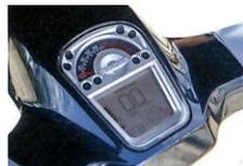
モダンレトロなデザインのメーターは上がアナログ式のスピード、下がデジタルタコメーター。LEDバックライトは7色から選択可能。
