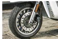
226mm径のディスクブレーキを採用し、前後連動ブレーキも標準装備。試乗車はフロントフェンダー可動式の「フレックス」タイプ。
