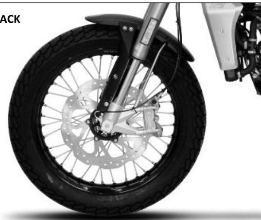
**⚠** 表面の状態と摩耗を確認してください。タイヤの状態が悪いとグリップと車両の操作性が損なわれます。タイヤが摩耗したりパンクした場合は交換してください。タイヤの修理や交換後はホイールバランスを調整してください。メーカー指定のサイズのタイヤのみを使用してください。指定外のタイヤの使用は車両の操作性や安定性を損ない、器物や人に障害を与え、重症あるいは死亡に至る事故を生じるおそれがあります。
