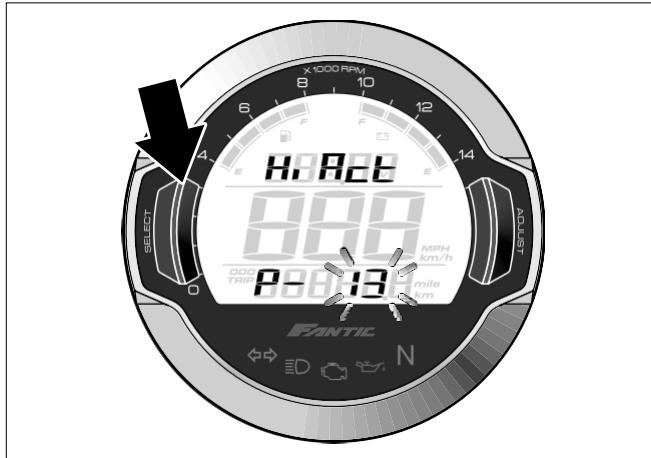
アジャスト(ADJUST)ボタンを押して正しい波形を選択します。
